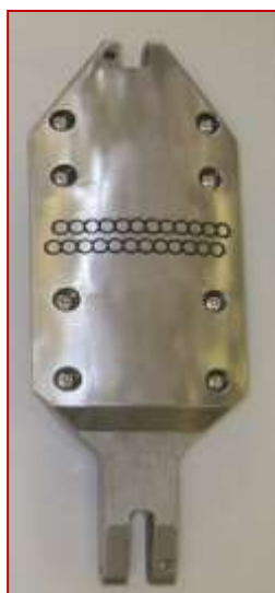
Figura 3. Detalle del patín que es parte principal de una herramienta CMI
